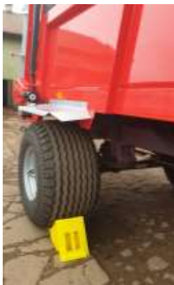
Rys. 16. Umieszczenie klinów pod koła maszyny
